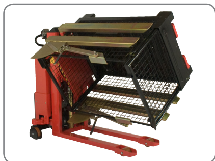
Kassen kan vendes med bunden i vejret, når Rotator er forsynet med boksholder med beslag.
