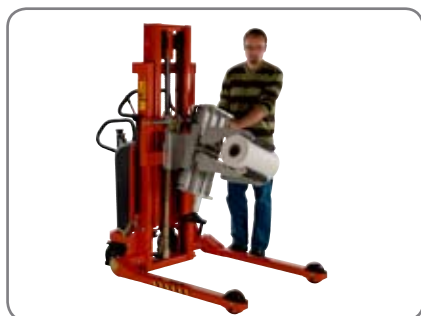
Rotation foretages manuelt, og rullen kan fastlåses i fire positioner.
